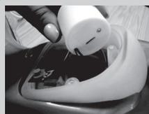
Troque as baterias observando as polaridades das mesmas, parafuse novamente a caixa de som e reposicione-a dentro do compartimento.
