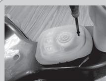
Com uma chave Philips, solte os parafusos e retire a tampa do painel do brinquedo.
