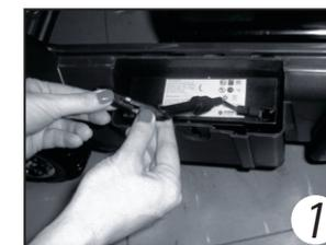
1 - Retire a tampa do tanque, localizado no lado esquerdo, com uma moeda ou chave de fenda e conecte o plugue da bateria no plugue do caminhão.
