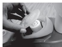
Cuidadosamente retire a caixa de som e solte o parafuso da parte inferior.
