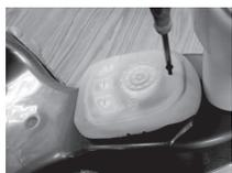
Com uma chave Philips, solte os parafusos e retire a tampa do painel do brinquedo.
